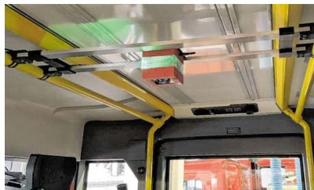
Der Würfel wurde an der Decke der Fahrerkabine angebracht, um herauszufinden, wie sich die Aerosole bei einem Feuerwehreinsatz verbreiten. BILD: FEUERWEHR ILVESHEIM
